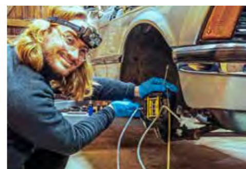
Tagelang plagt Max und Sven das Entlüften der Bremse. Den Unterboden konservieren sie akribisch
